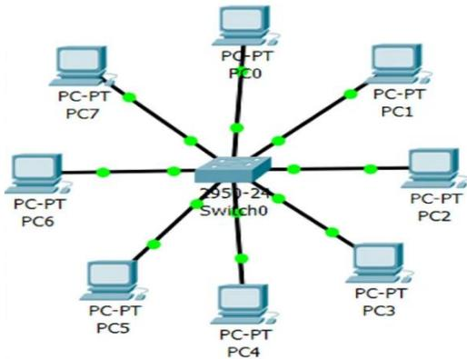
Con la topología en estrella de la figura diseñe una tabla con dos departamentos y dos redes diferentes los equipos **Pc0, Pc7, Pc1 pertenecen a el departamento de sistemas** y los restantes a contabilidad utilizar direcciones ip clase C.
